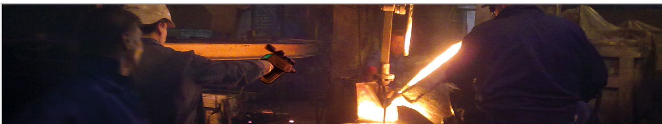
Berührungslose Temperaturmessung aus einer sicheren Entfernung
